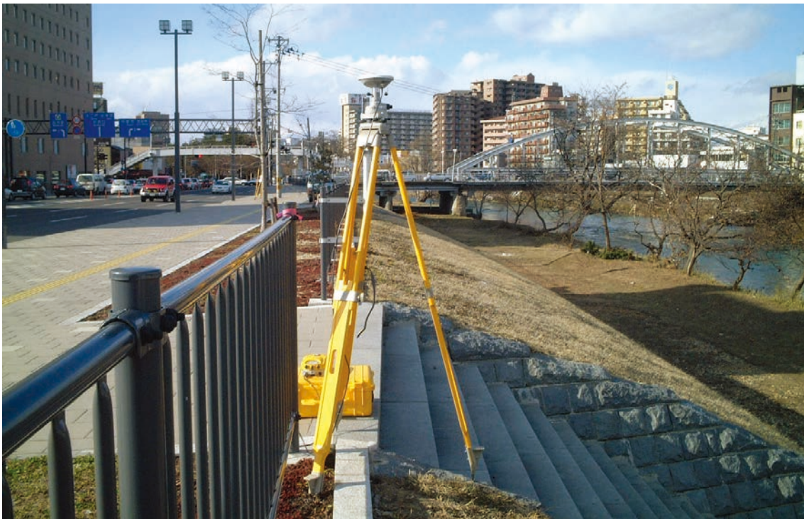
盛岡市開運橋のGNSS観測（盛岡地区）
